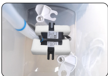
1. Remova a espuma ao redor da bomba.
