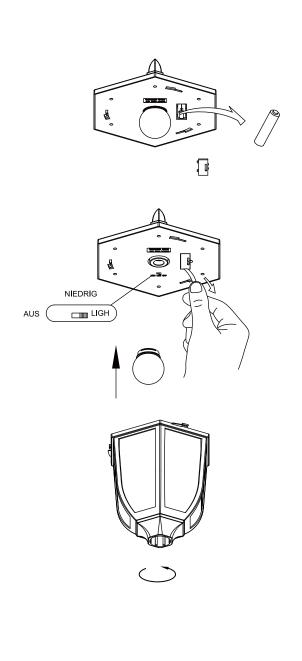
**Schritt 1:** Montieren Sie Objektivteil und Deckel zusammen, indem Sie die Verriegelungslaschen an der Seite des Objektivteils an den Schlitzen an der Unterseite des Leuchtenkopfs ausrichten und im Uhrzeigersinn drehen, um ihn zu verriegeln.
