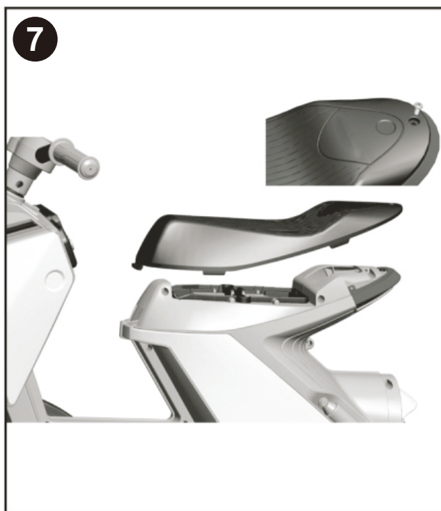
7 Assemblaggio sella Inserire la sella nelle apposite fessure della carrozzeria, stringere con una vite.
