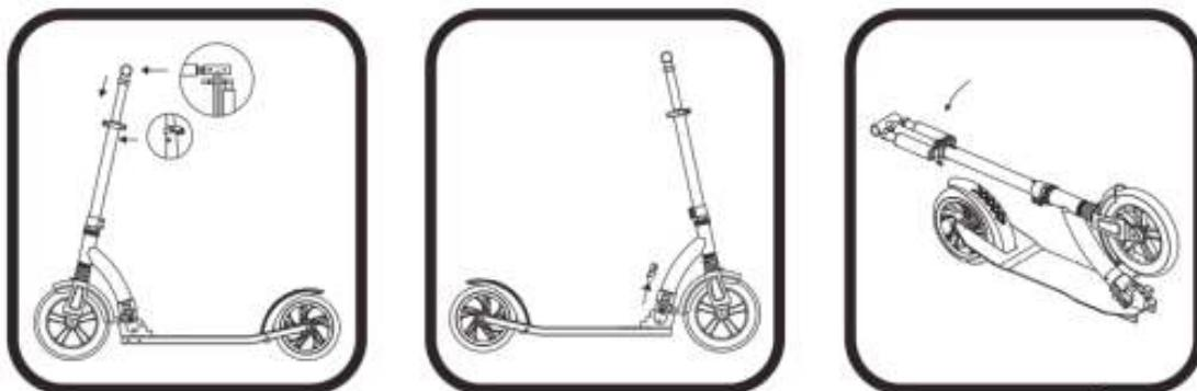
Afloje el bloqueo superior, presione el botón de resorte y empuje hacia abajo la barra en T hasta la altura más baja.
