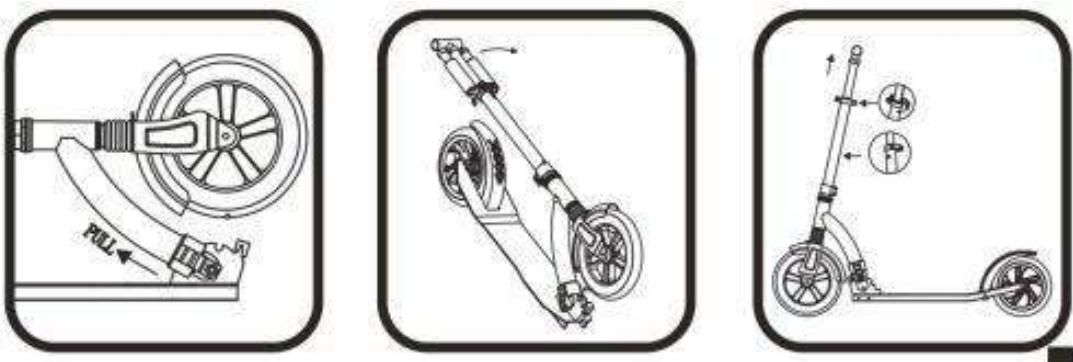
Aprire verso l'alto il morsetto in plastica per sbloccare il sistema di estensione dello scooter e tirare l'asse manubrio. Quando sentirete un click, lo scooter e' completamente esteso.
