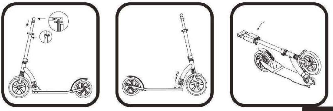
Desserrez la serrure supérieure, appuyez sur le bouton de ressort et appuyez sur la guidon au niveau de hauteur le plus bas. Puis serrez la serrure supérieure pour fixer la guidon .
