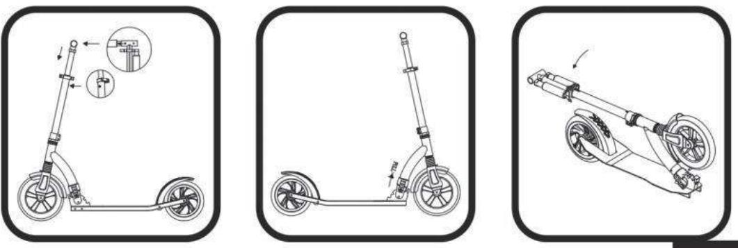
Lösen Sie zuerst die obere Verriegelung, drücken Sie den Federknopf und drücken Sie die Lenkstange auf die niedrigste Höhe. Ziehen Sie dann die obere Verriegelung fest, um den Lenkstab zu sichern.
