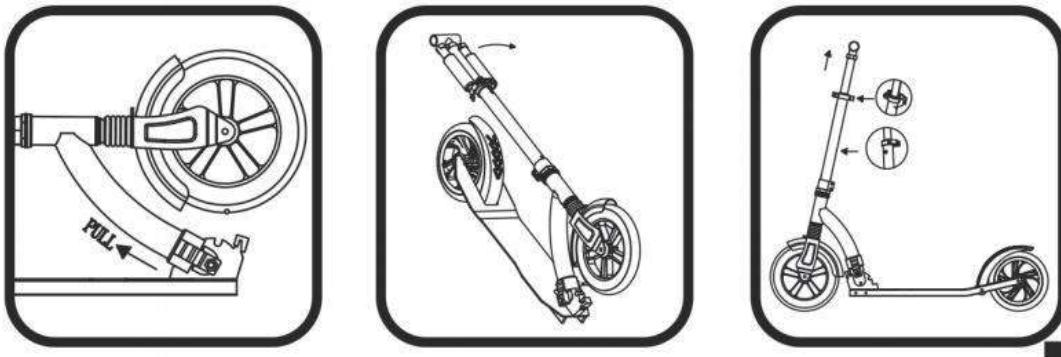
Bitte ziehen Sie zuerst die Kunststoffschiebehülse nach oben, um das Klappsystem zu entriegeln und ziehen Sie am Lenkervorlauf. Wenn Sie ein Klickgeräusch hören, ist der Roller vollständig ausgeklappt.
