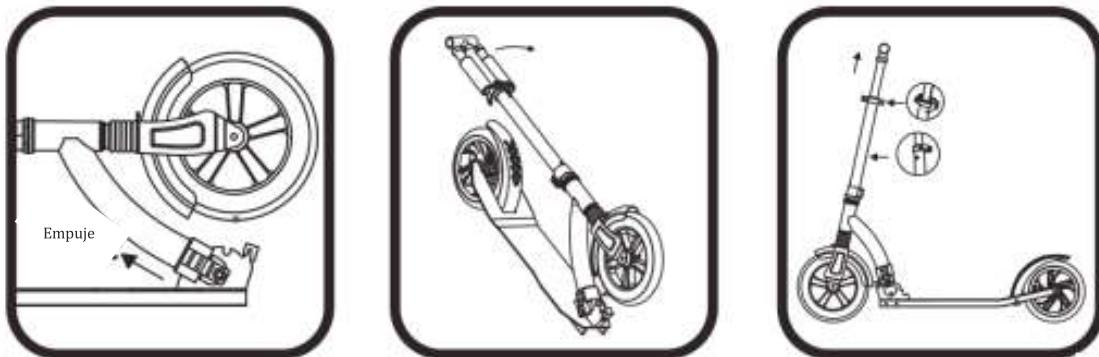
Presione el botón de plegado y tire del manillar hacia arriba hasta que oiga el clic. Suelte el manillar del soporte e insértele en la barra en T, asegurándose de que el botón de resorte salte para fijarlo en su posición.
