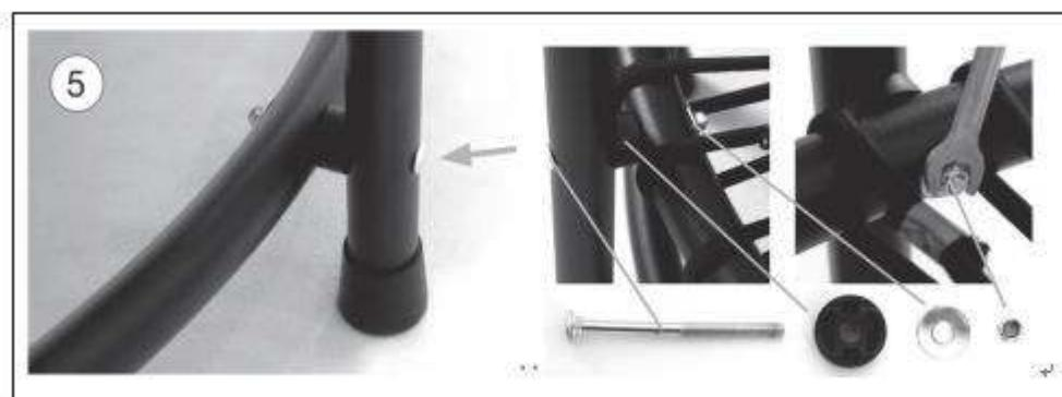
4. Bringen Sie die beiden kurzen Schrauben an zwei Seiten des Steckverbinders mit dem Werkzeug „L“ an.
