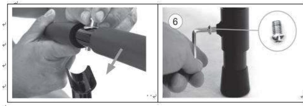
5. Trovare la barra a T superiore (TR06) e la barra di regolazione (TR07), installarle come mostrato.
