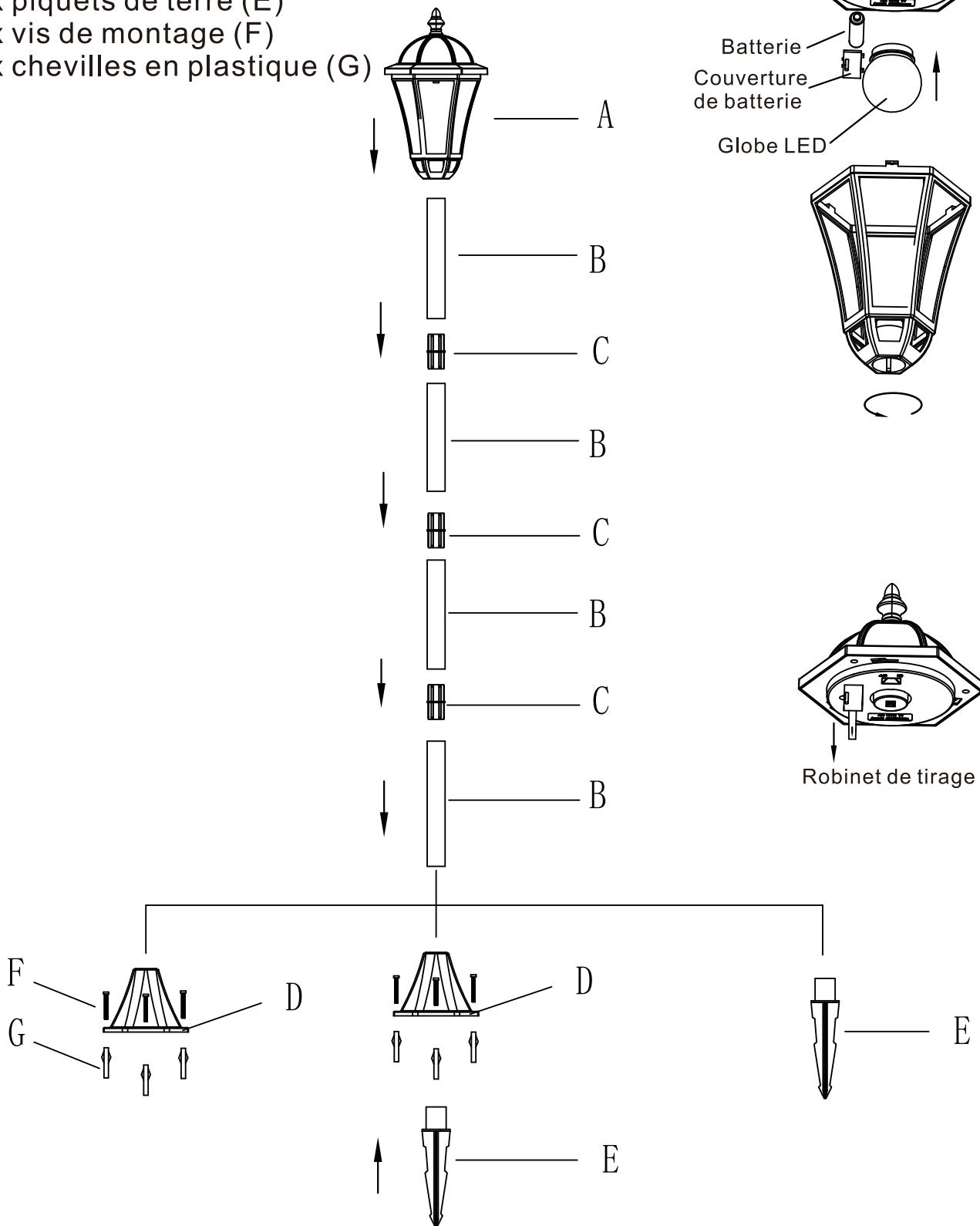
**Étape 1 :** Fixez les poteaux avec en reliant B entre les 3 sections de poteau avec les attaches de poteau C. Fixez les pièces de poteau avec les attaches de poteau ensemble.
