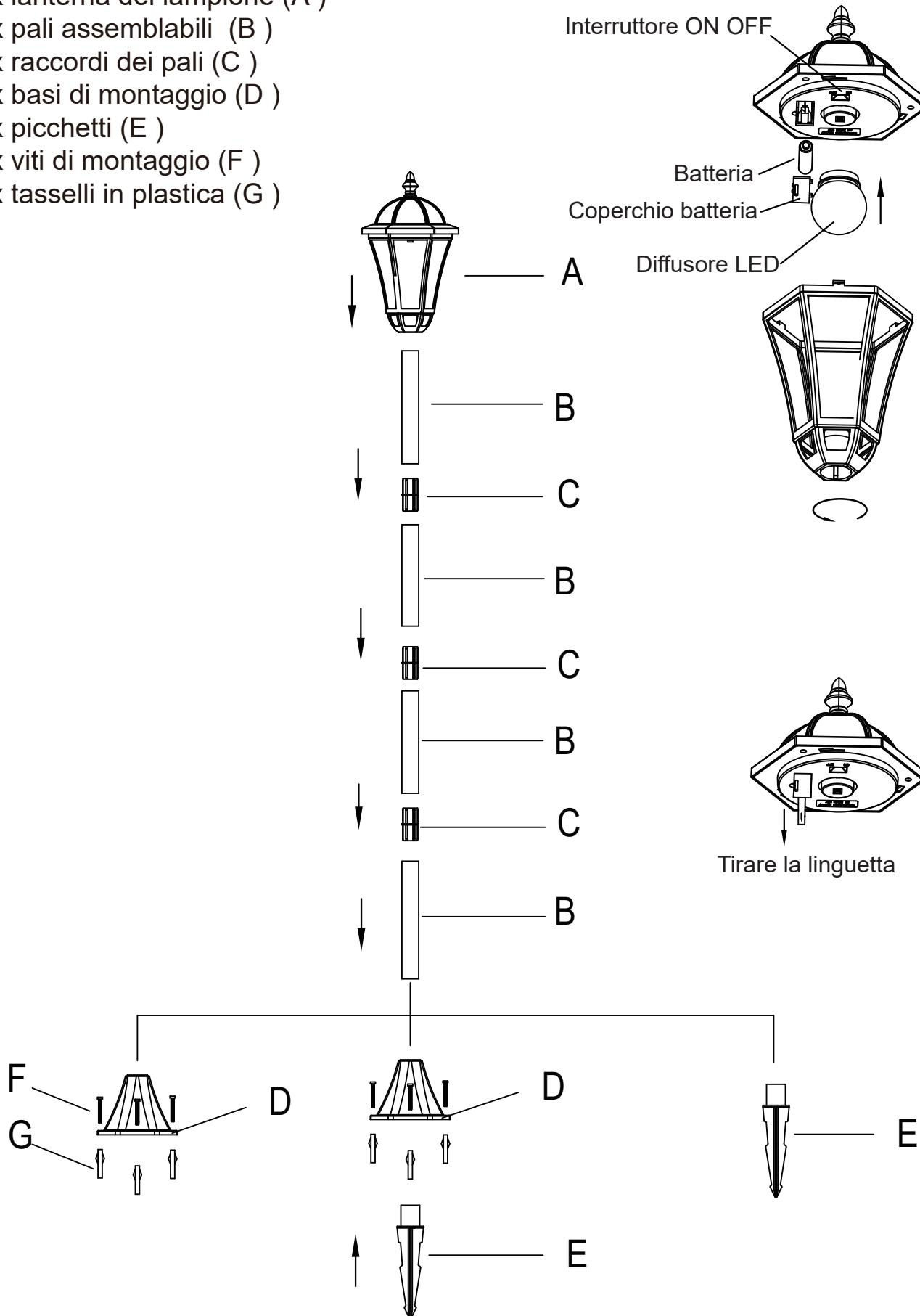
Passo 1: Assemblare i pali B collegandoli tra le 3 sezioni con i raccordi dei pali C. Fissare insieme i pali con gli appositi raccordi.
