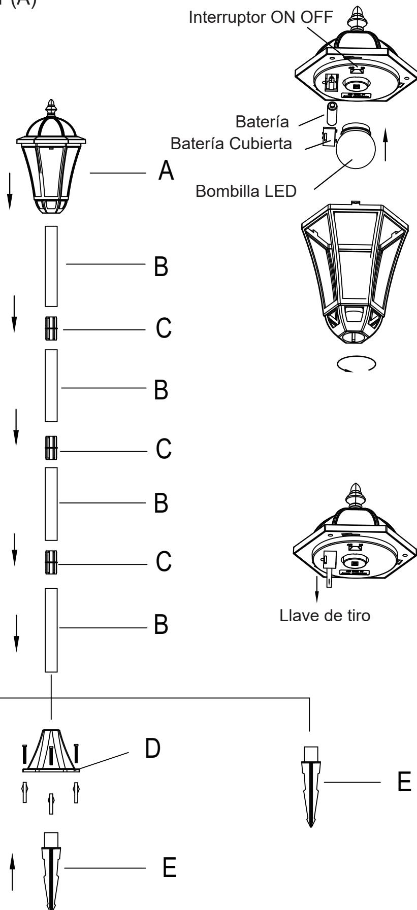
Paso 1: Ensamble los postes conectando B entre las 3 secciones de postes con los accesorios para postes C. Fije las piezas de los postes con los accesorios para postes.
