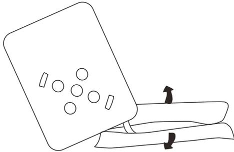
Strappare il velcro inferiore ed estrarre la batteria.
