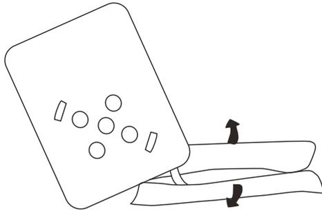
Reißen Sie den unteren Klettverschluss ab und nehmen Sie die Batterie heraus.
