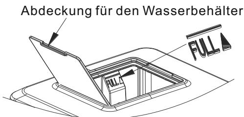
Warnung: Gießen Sie kein Wasser in den internen Wassertank, der sich unter dem Eiskorb befindet. Dieser Tank ist nicht groß genug und beeinträchtigt die Leistung der Eisherstellung.
