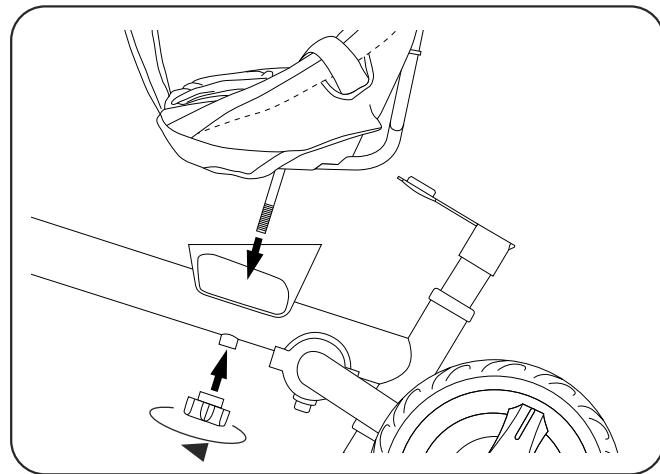
7. Comme indiqué sur l'image, dévissez d'abord le bouton de fixation de la selle de l'écrou, puis faites passer la vis sous la selle à travers le trou du cadre principal, puis serrez le bouton de fixation de la selle jusqu'à ce que la selle soit bien fixée et ne bouge pas.
