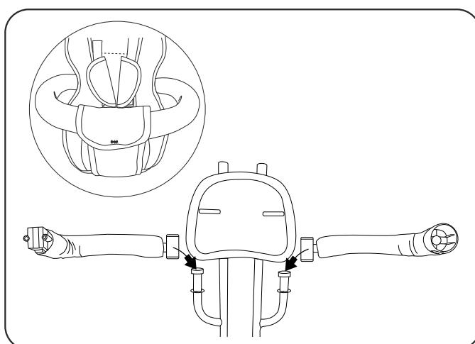
8. Como se muestra en la imagen, desliza las partes izquierda y derecha del marco a lo largo de las ranuras de la ranura de inserción hacia abajo, luego pasa a través de la barra delantera de la cubierta del asiento, luego cierra las partes izquierda y derecha del marco.
