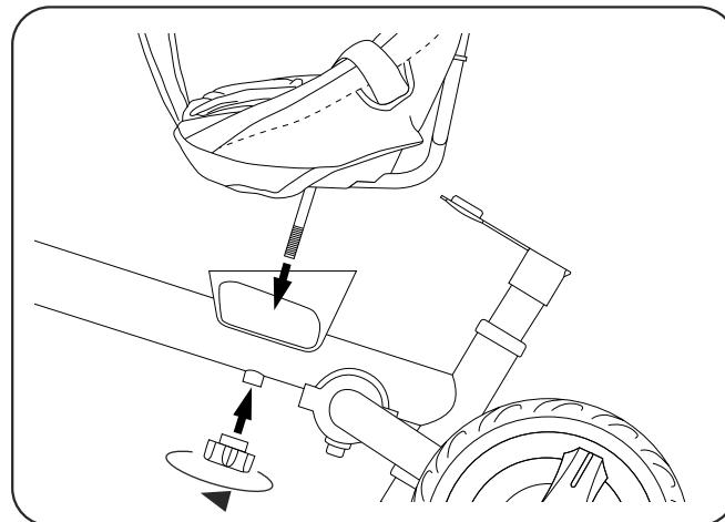
7. Como se muestra en la imagen, primero desenrosca el perno del botón de fijación del asiento en el perno, luego permite que el perno debajo del asiento pase a través del agujero en el marco principal, luego aprieta el perno del botón de fijación del asiento hasta que el asiento no se mueva.
