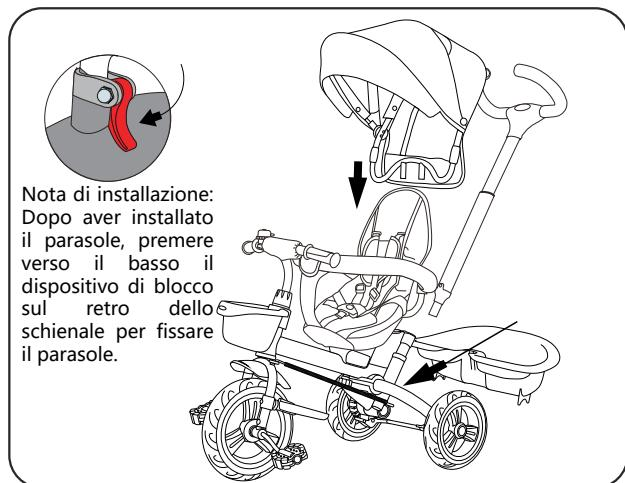
9. Come mostrato in figura, inserisci per prima l'asta di spinta nel tubo di collegamento sul retro del sedile, fino a sentire l'aggancio con un "clic". Appesi il porta biberon; quindi allinea e infila l'apertura del tendalino nell'apertura del poggiapiede e fissala; infine, posiziona correttamente il cesto e fissalo con il pomello di fissaggio del cesto.
