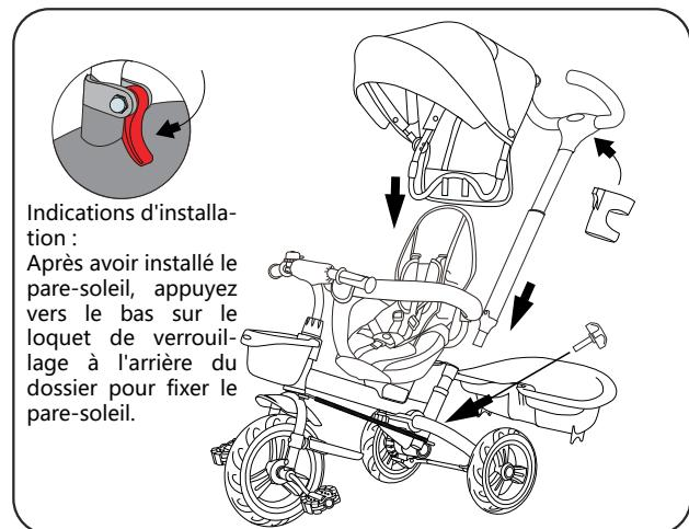
9. Comme indiqué sur l'image, insérez d'abord la barre de poussée dans le tube de raccordement à l'arrière du siège jusqu'à ce qu'elle se verrouille avec un bruit de "clic", complétez la fermeture, accrochez le porte-bouteille ; puis alignez et insérez l'embout du parasol dans l'orifice du dossier et verrouillez-le ; enfin, positionnez correctement le panier et fixez-le avec le bouton de fixation du panier.
