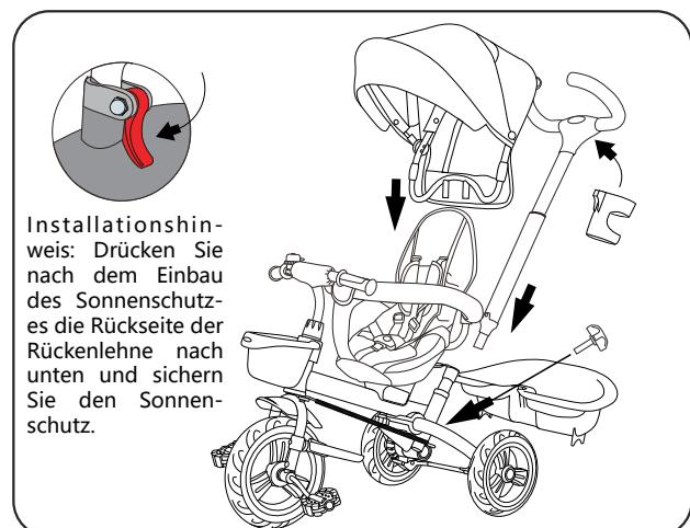
9. Wie auf dem Bild gezeigt, stecken Sie zuerst die Druckstange in das Verbindungsrohr hinten am Sitz ein, bis sie mit einem "Klick" einrastet. Hängen Sie dann die Flaschenhalterung auf; richten Sie dann das Rohr des Sonnendachs mit dem Rohr der Rückenlehne aus und stecken und verriegeln Sie es; positionieren Sie schließlich den Korb richtig und befestigen Sie ihn mit dem Korb-Befestigungsknopf.
