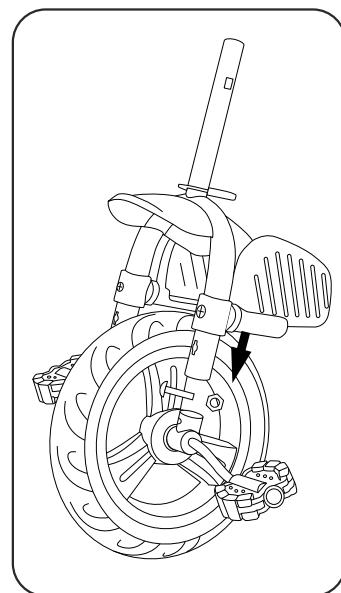
1. Come mostrato in figura, inserisci l'asse della ruota posteriore nell'incavo della ruota posteriore del telaio principale, picchiettando leggermente fino a sentirlo bloccarsi con un "clic".
