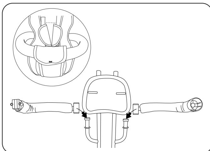
8. Wie auf dem Bild gezeigt, schieben Sie die linken und rechten Teile des Rahmens entlang der Rillen der Einsteköffnung nach unten, dann führen Sie sie durch die Frontleiste des Sitzkissenbezugs und schließen Sie die linken und rechten Rahmen.
