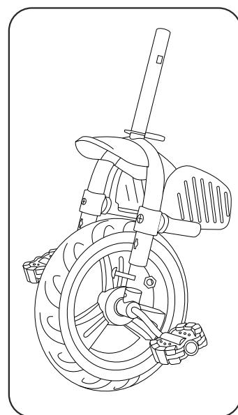
1. Como se muestra en la imagen, inserta el eje de la rueda trasera en el agujero de inserción de la rueda trasera del marco principal, golpea suavemente hasta que encaje con un sonido de bloqueo "clic".
