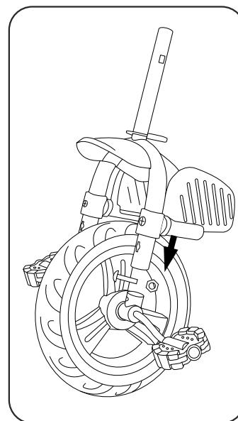
1. Comme indiqué sur l'image, insérez l'axe de la roue arrière dans l'orifice de fixation de la roue arrière du cadre principal, tapotez légèrement jusqu'à ce qu'il se verrouille avec un bruit de "clic".
