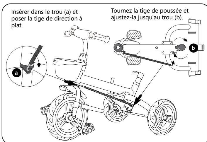
4. Comme indiqué sur l'image, insérez d'abord l'ensemble de la roue avant dans le cadre principal ; placez la corbeille avant, puis insérez le couvercle avant sur le tube de guidon, puis insérez le tube de guidon dans le tube supérieur de la fourche avant, alignant les trous de vis de la fourche avec ceux du guidon, passez les vis de fixation du guidon à travers les trous ; puis serrez-les à l'aide d'une clé à douille, abaissez le couvercle avant ; enfin, installez la sonnette sur le guidon.
