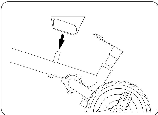
6. Como se muestra en la imagen, coloca la base de fijación del asiento en el marco.
