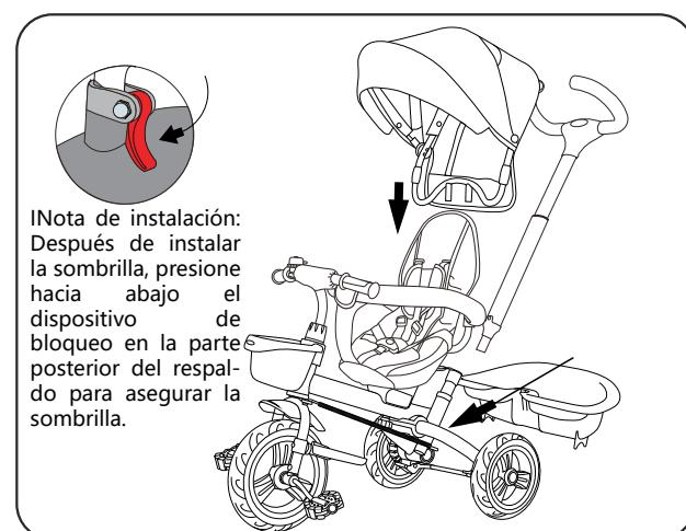
9. Como se muestra en la imagen, primero inserta la varilla de empuje en la conexión posterior del asiento hasta que encaje con un sonido de bloqueo "clic". Cuelga el portabotellas; luego alinea e inserta el extremo del tubo del toldo en el extremo del respaldo y fíjalo; finalmente, asegura correctamente la cesta y fíjala con la perilla de fijación de la cesta.
