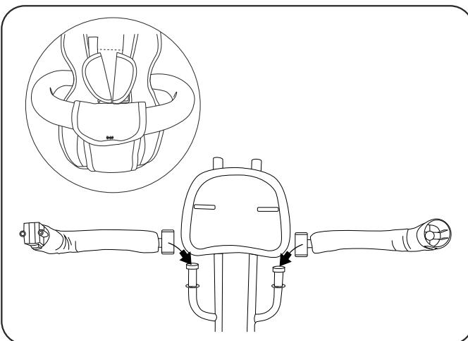
8. Comme indiqué sur l'image, faites glisser les parties gauche et droite du cadre le long de la rainure de l'encastrement, puis passez-les à travers la barre avant de la housse de siège, puis fermez les parties gauche et droite du cadre.
