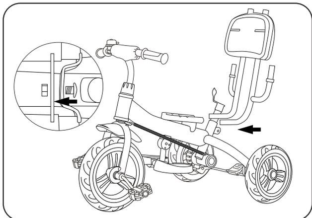
6. Comme indiqué dans l'image, insérez le support de barrière dans le tube du siège et fixez-le avec des vis.
