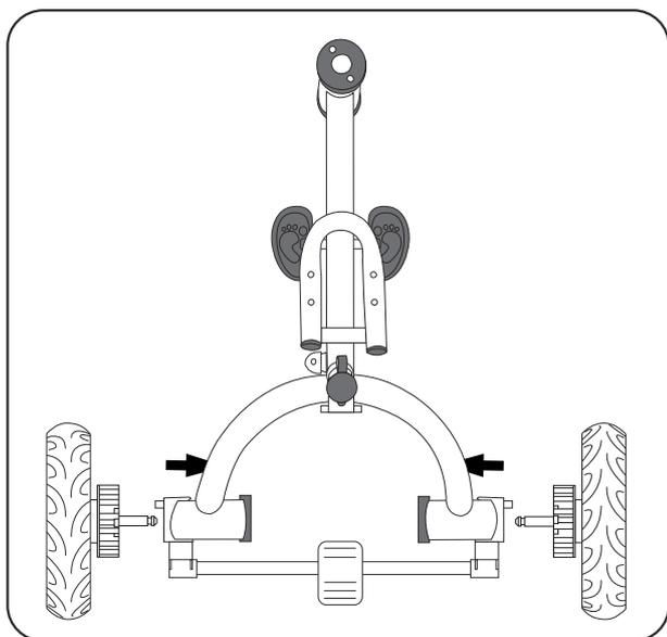
1. Come mostrato in figura, inserisci l'asse della ruota posteriore nell'incavo della ruota posteriore del telaio principale, picchiettando leggermente fino a sentirlo bloccarsi con un "clic".
