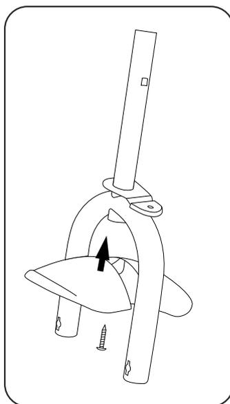
2. Come mostrato in figura, fissa il parafrangente anteriore alla forcella anteriore con le viti (la forcella anteriore e fissa-scandalatura a forma di la con la vite e l'attacco a mezzaluna deve essere rivolta in avanti).
