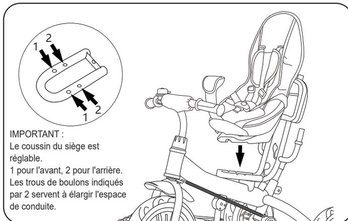
7. Comme indiqué dans l'image, alignez le siège avec les trous de vis du cadre et fixez-le avec des vis.
