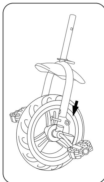
3. Come mostrato in figura, inserisci per prima la testa di guida nella forcella anteriore e fissa-scandalatura a forma di la con la vite e l'attacco a mezzaluna deve essere dato.
