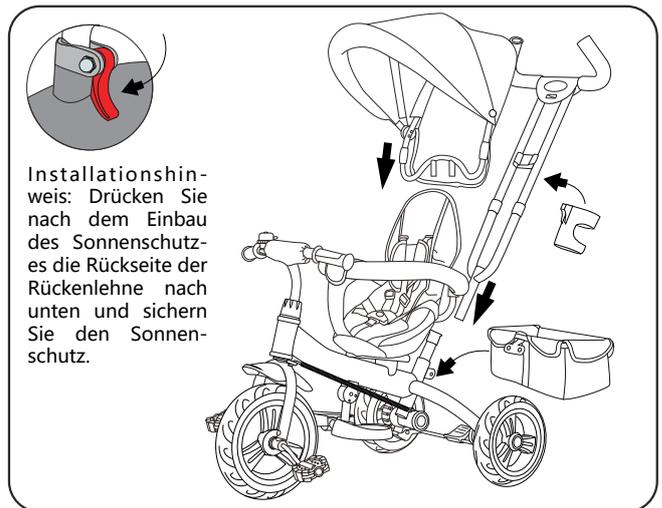
Installationshinweis: Drücken Sie nach dem Einbau des Sonnenschutzes die Rückseite der Rückenlehne nach unten und sichern Sie den Sonnenschutz.
