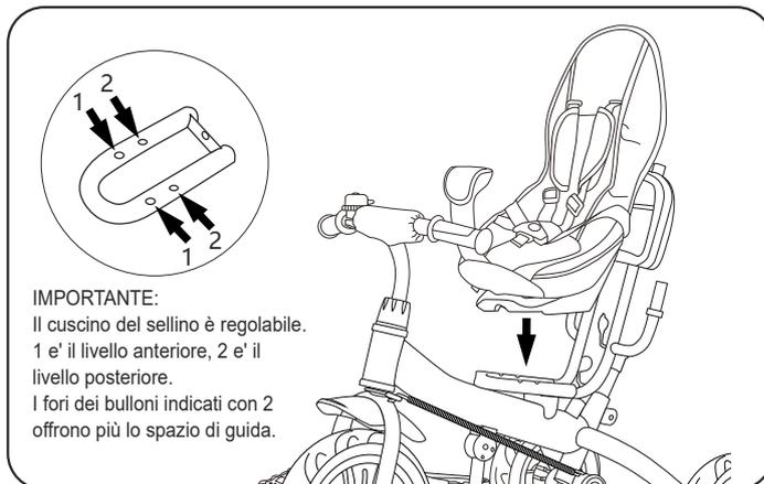
7. Come mostrato nell'immagine, allineare il sedile con i fori filettati del telaio e fissarlo con le viti.
