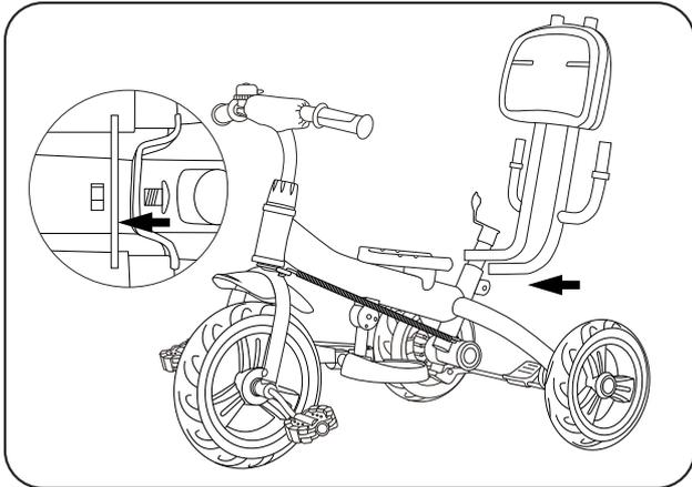
6. Setzen Sie die Geländerhalterung gemäß der Abbildung in die Sitzrohr ein und befestigen Sie sie mit Schrauben.
