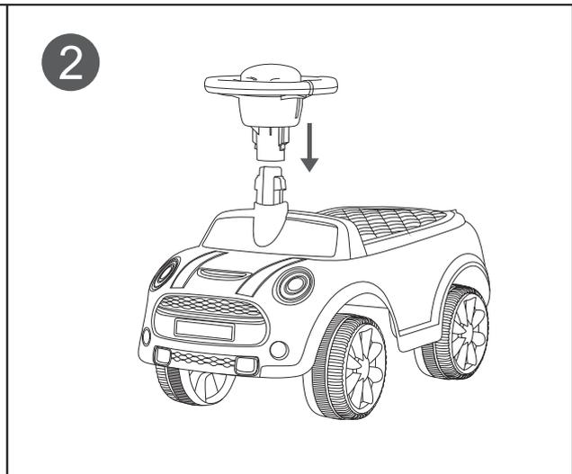
2 Bauen Sie das Lenkrad mit Schraube A wie in der Abbildung gezeigt zusammen.
