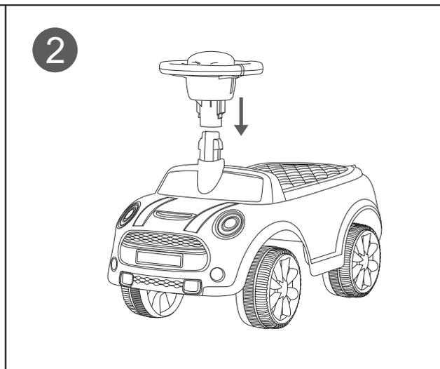
2 Ensambla el volante con el tornillo A como se muestra en la figura.
