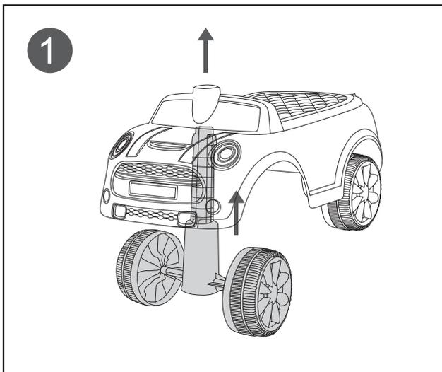
1 Permite que la rueda delantera atraviese el cuerpo del automóvil como se muestra en la figura.
