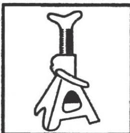
Le poids doit être soutenu par un ensemble de chandelles de levage d'une capacité appropriée avant que tout travail ou inspection ne puisse être effectué sur le véhicule. Ne pas dépasser la capacité nominale sous peine de perte de charge.
