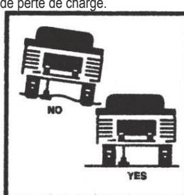
Ce cric est conçu pour une utilisation sur des surfaces dures et de niveau uniquement. L'utilisation sur des surfaces inégales ou instables pourrait entraîner une instabilité et éventuellement une défaillance du support de charge.
