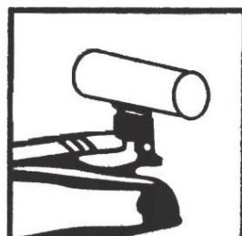
Siempre coloque la carga en el centro de la montura del gato para obtener un soporte más estable.
