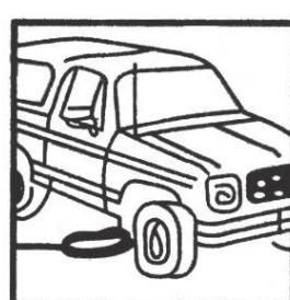
Centrer toujours le cric sous l'essieu ou une surface de châssis renforcée et plate.
