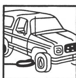
Siempre centre el gato debajo del eje o en una superficie plana reforzada del marco.
