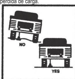
Este gato está diseñado para ser utilizado en superficies duras y niveladas. Utilizarlo en superficies irregulares o inestables podría resultar en inestabilidad y posibilidad de que no soporte la carga con éxito.
