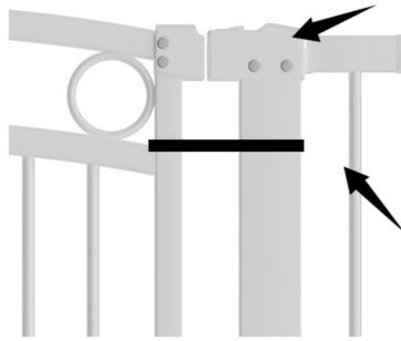
La brecha de la puerta NO es un defecto, se disminuirá a 0,2 cm después de la instalación.
