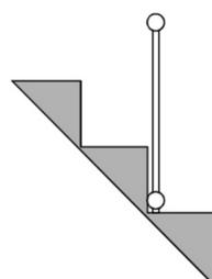
Si la barrière est utilisée au bas d'un escalier pour empêcher l'enfant de monter, elle doit être installée sur la marche la plus basse.
