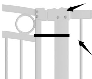
L'écart entre les portes n'est PAS un problème ! Après l'installation, il sera réduit à 0,2 cm.
