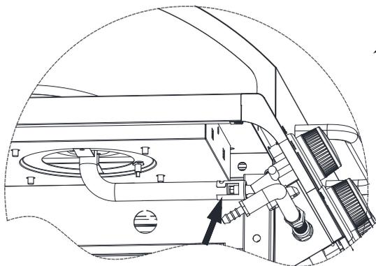
Posición correcta del tubo del quemador lateral
