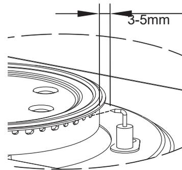
Después de montar el quemador lateral, inserte el cable de encendido en el pasador de encendido
